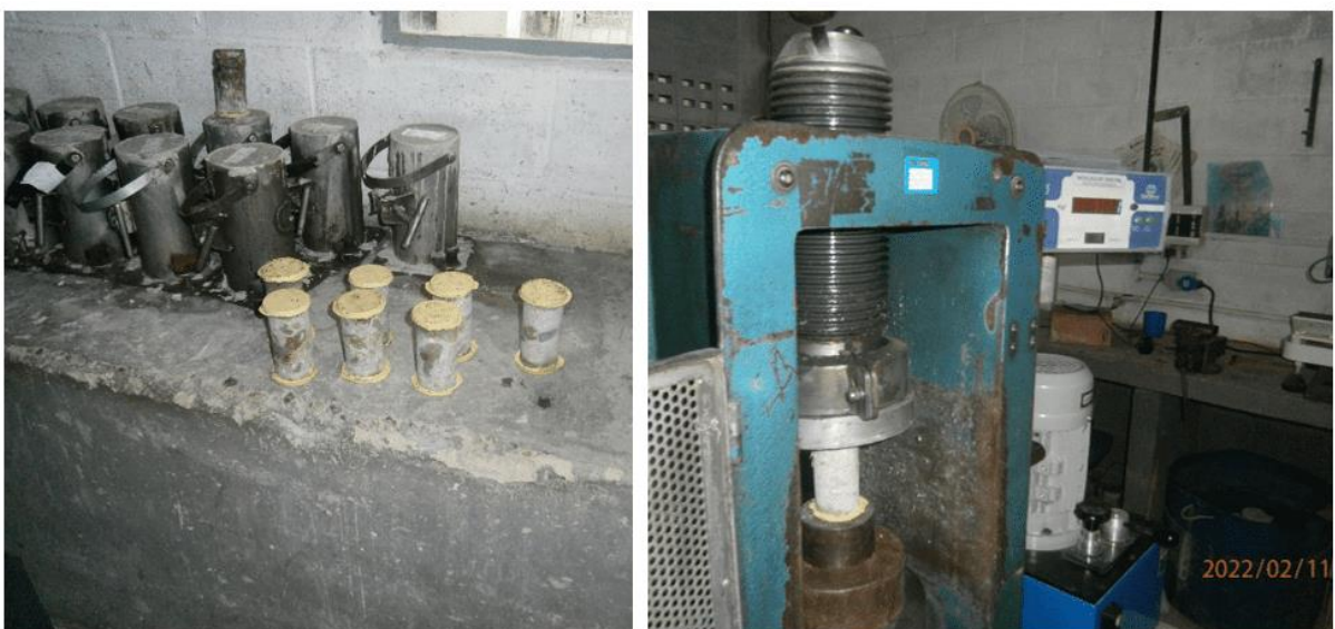
Figura 9: Procedimentos de ensaio: a) Corpos de prova capeados com enxofre (figura à esquerda); b) Equipamento de ensaio (figura à direita)
