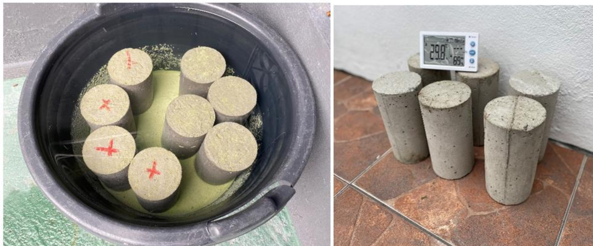
Figura 10: Procedimientos de curado y medición de humedad y temperatura: a) Cuerpos sumergidos en solución (figura a la izquierda); b) Cuerpos expuestos al aire libre (figura a la derecha)
