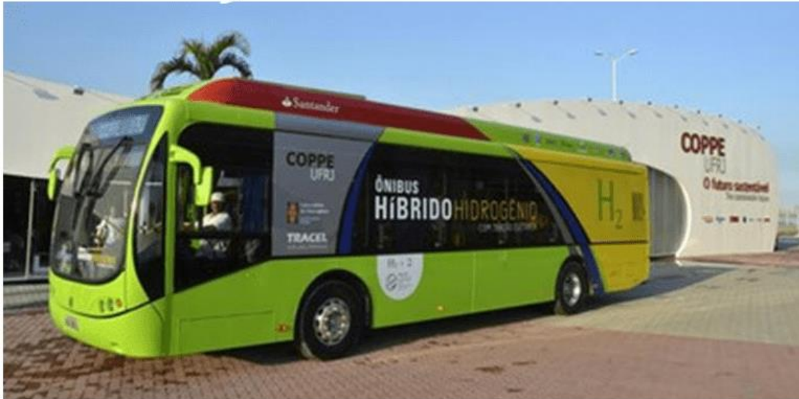
Figura 2. Ônibus movido a H 2 criado na UFRJ
