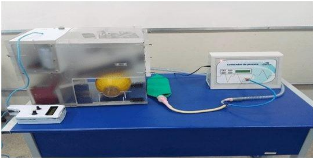
Figura 4 – Cenário de testes de pressão inspiratória com o protótipo
